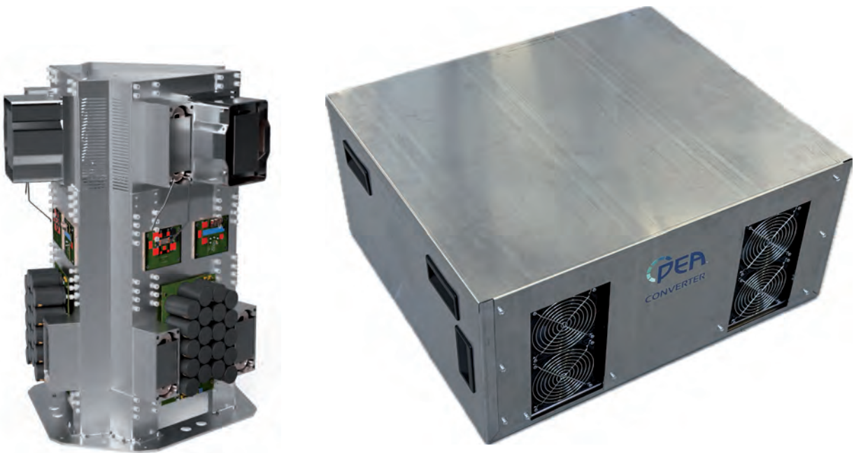
Abb. 28: Links: Aufbau eines dreiphasigen Leistungsmodul mit 75 kW Ausgangsleistung, bestehend aus PFC-Wandler (unten), Inverter und Gleichrichter (mitte) und Spule und Transformator (oben). Rechts: Leistungseinheit der bidirektionalen Leistungselektronik.
